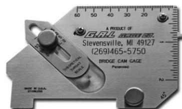
Les mesures suivantes sont possibles en pouces ou en millimètres : angle de préparation, métal à souder excessive, profondeur de décompression, profondeur de piqure, taille de la garniture de soudure et plus encore.
